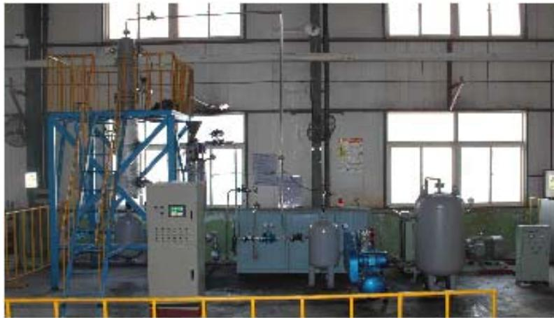
图 12 除尘效率测试平台
