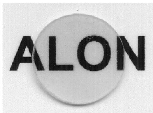
图 19 微波烧结制备的 AION 样片<sup>[104]</sup>
