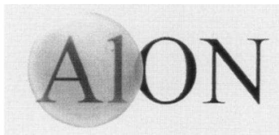
图 18 SPS 烧结制备的 AION 透明陶瓷<sup>[103]</sup>
