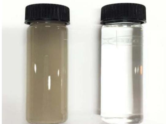
图 6 陶瓷平板膜过滤效果
