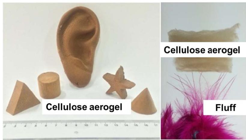
图 14 超轻纳米纤维气凝胶<sup>[153]</sup>
