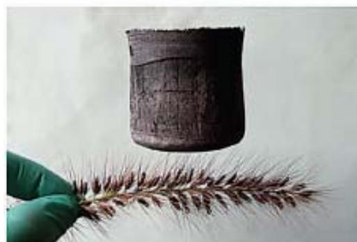
图 22 超轻碳气凝胶图像 (“碳海绵”)<sup>[251]</sup>
