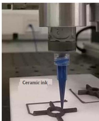
图 9 墨水直写成型原理
