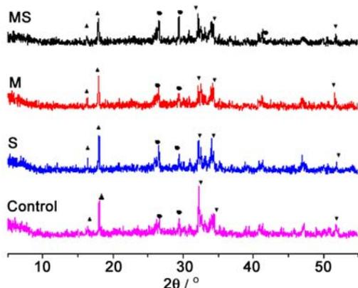
图 5 养护 1 d 的水泥水化产物 XRD 衍射图谱
