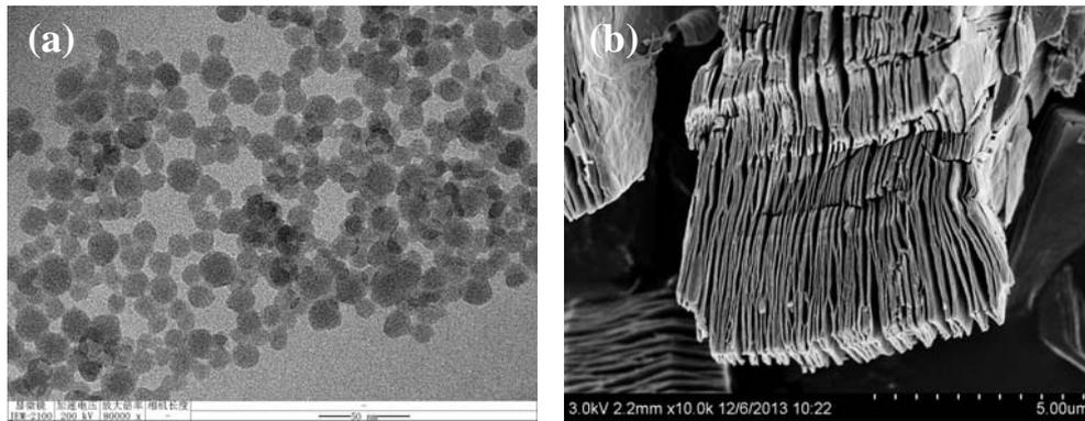
图 1 (a) 硅溶胶的 TEM 照片; (b) MXene 的 TEM 图片
