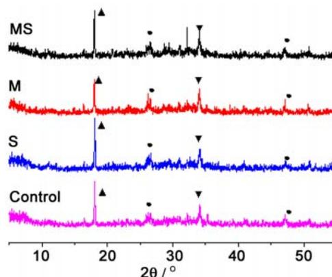
图 6 养护 28 d 的水泥水化产物 XRD 衍射图谱
