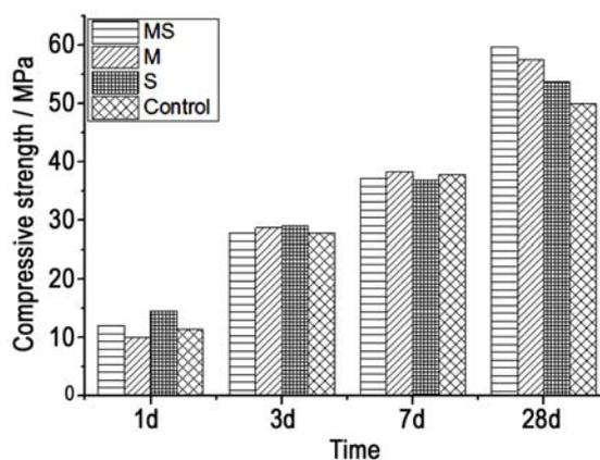
图 2 掺纳米 SiO<sub>2</sub> 和 MXene 对粉煤灰水泥抗压强度的影响
