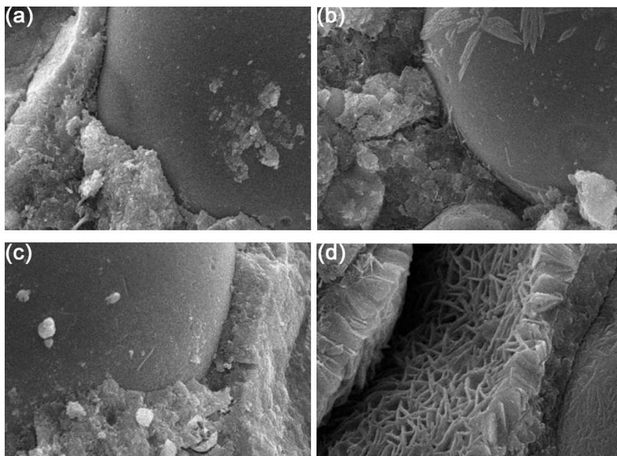
图 4 养护 7 d 的粉煤灰水泥的扫描电镜照片: (a) control; (b) S; (c) M; (d) MS
