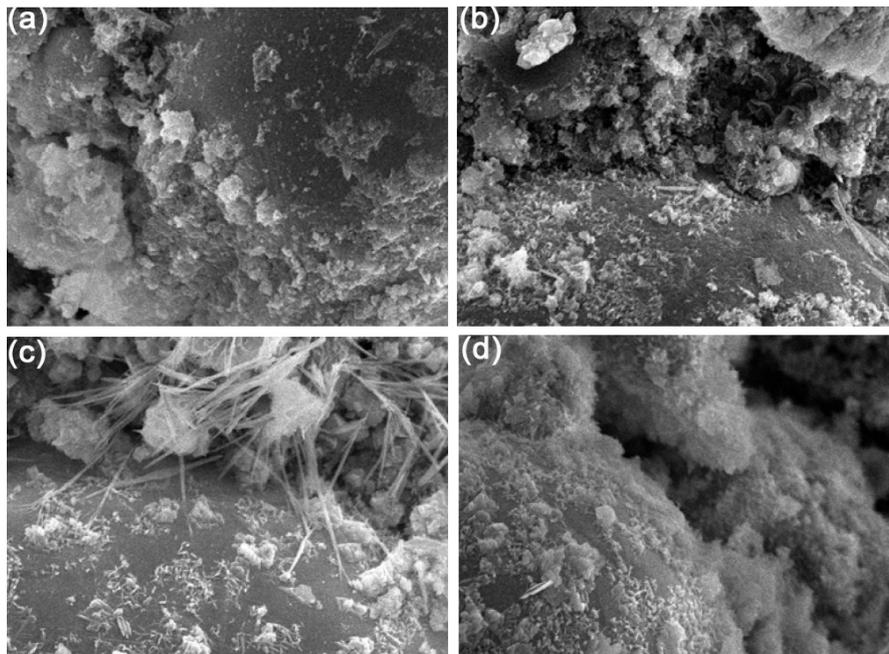
图 3 养护 1 d 的粉煤灰水泥的扫描电镜照片: (a) control; (b) S; (c) M; (d) MS
