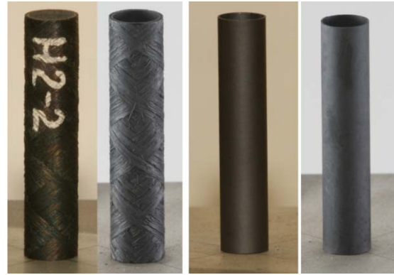
图 22 SiC f /SiC 复合材料及单质 SiC 包壳管辐照前后形貌
